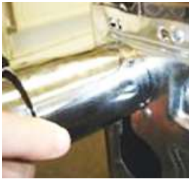
Obrázek 5. Nohu pevně zašroubujte tak, aby byl podstavec trouby sevřen mezi podložkou a horní částí nohy. Po upevnění všech čtyř nožiček zvedněte sporák na nožičky a dbejte na rovnoměrné rozložení hmotnosti na všechny čtyři nožičky současně. NEKLOPTE spotřebič na nohy, vždy jej zvedejte na nohy. (K tomu jsou zapotřebí dvě osoby)
