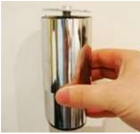
Obrázek 2. Sestava nohou se správně nasazenou podložkou. Spodní část nohy se odšroubuje, aby bylo možné nastavit výšku a úroveň sporáku.
